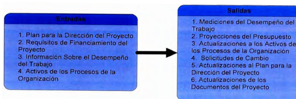
Fig. 2.3.4.6 Controlar los Costos: Entradas y Salidas
