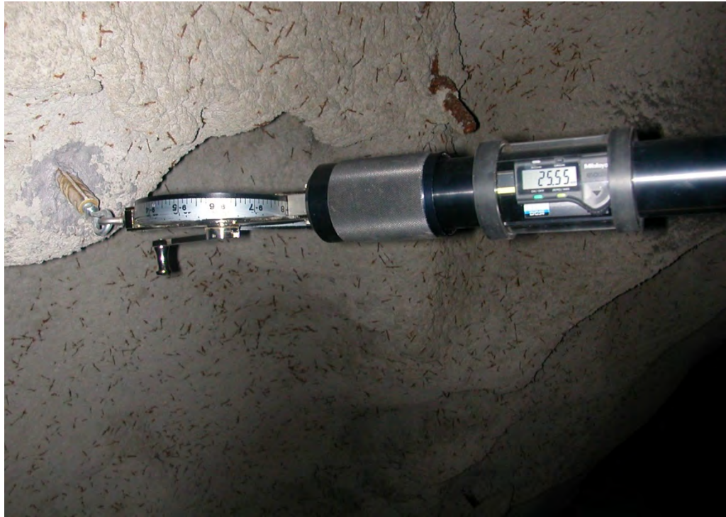
Figura 8.1: Extensómetro para medir convergencias en túneles
