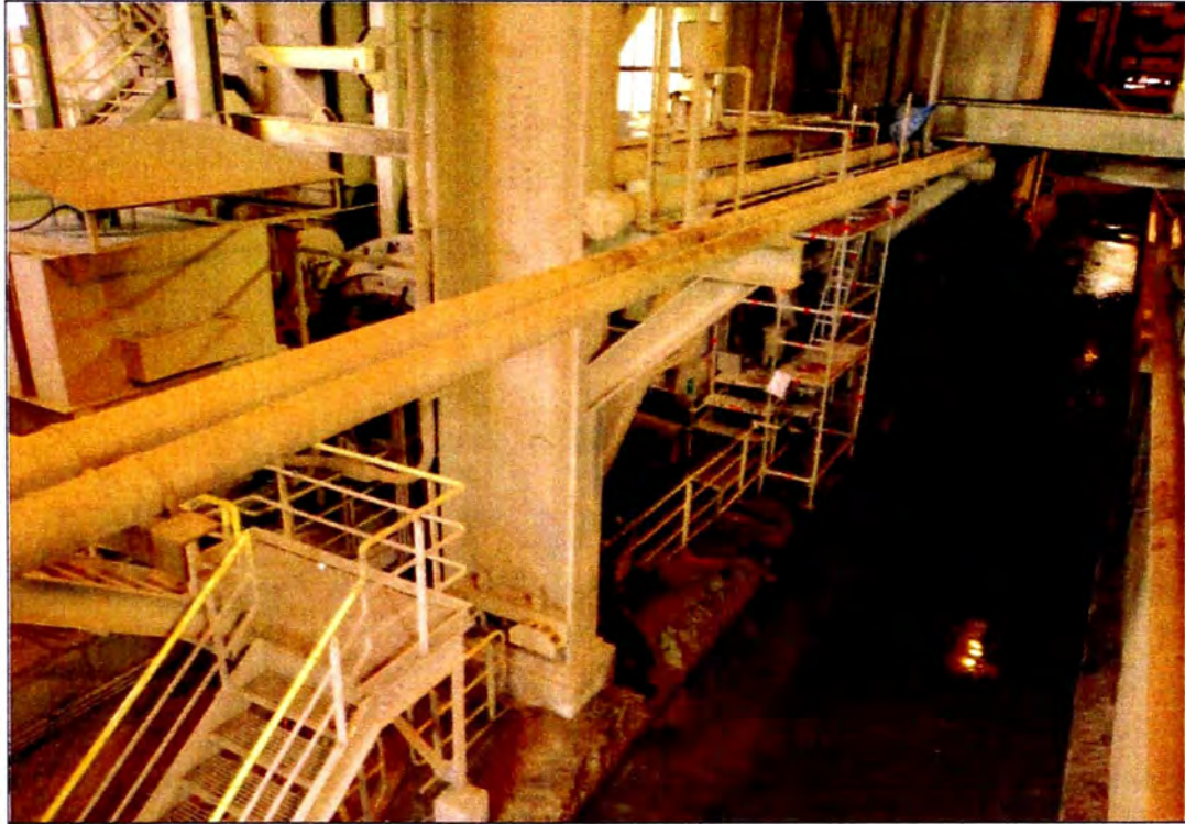
Ilustración 2.4: Canal de recojo de aguas y concentrado del área de molienda de la planta concentradora
