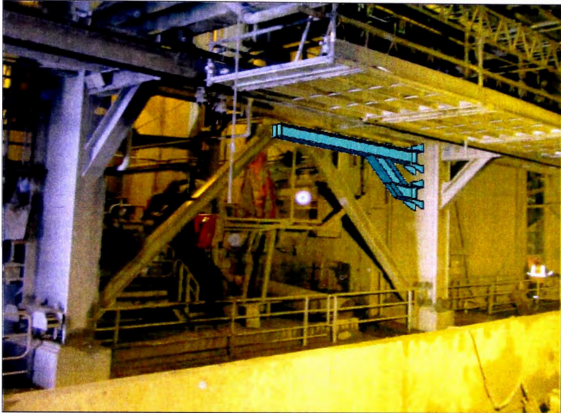
Ilustración 3.141: Esquema de estructura pescante
