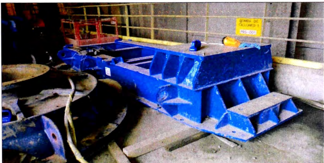
Ilustración 3.15: Bastidor de bomba R
