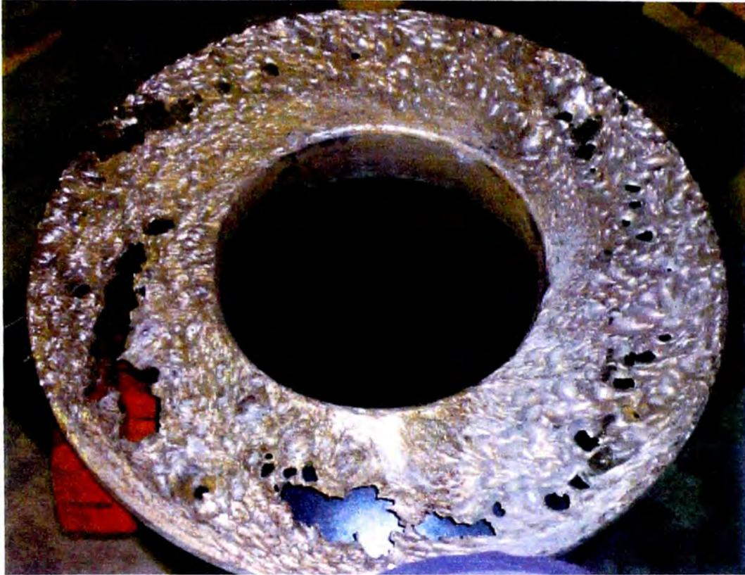
**Figura 4.6 Estado de las partes húmedas de la Bomba Warman modelo 16/14TU-AH**
