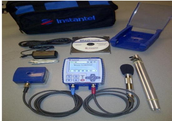
Figura 44. Equipo Micromate System (ISEE) de Monitoreo Avanzado de Vibraciones y Sobrepresión y Geófono Triaxial Estándar Instantel (versión ISEE o DIN) de 4 canales Fuente: http://slideshowes.com/doc/901863/seguridad---blasters-tool-and-supply
