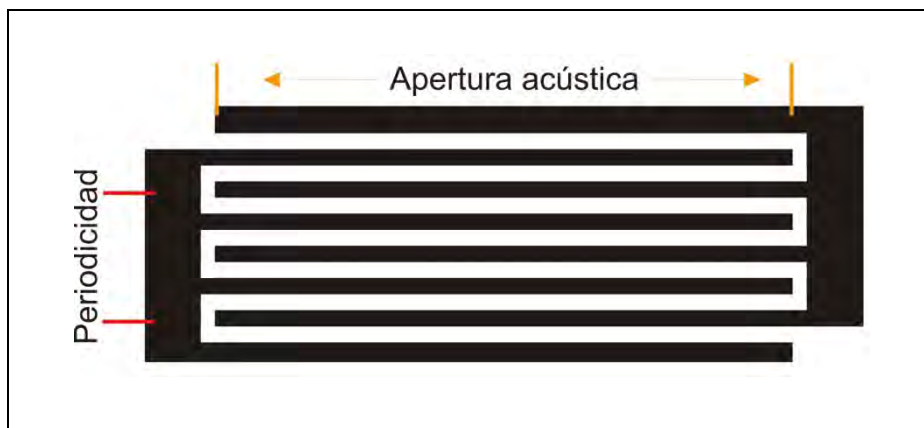
Figura 1.14: Características del transductor interdigital.
