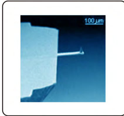
Figura 1.9: Cantilever de un microscopio.
