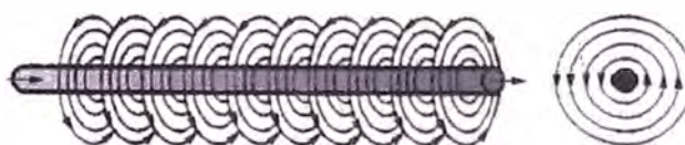
Figura 2.15 – Campo Magnético Alrededor de un Conductor Eléctrico
