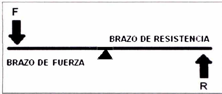
Fig. 2.1.a. Principio de palanca
