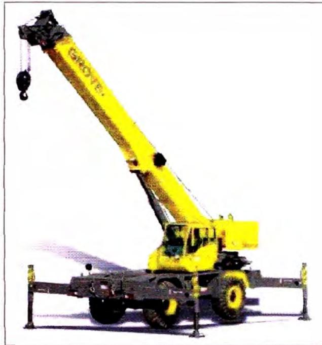
*Fig. 2.1.1.3. Grúa telescópica de 30 Ton*
