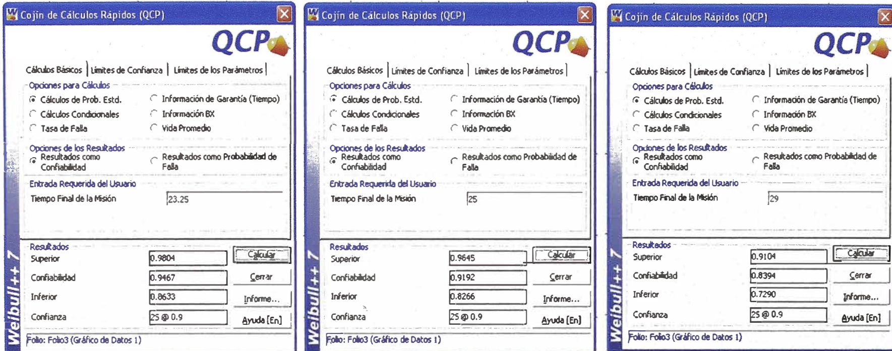
Fig. 4. 19. Confiabilidad de la tubería hasta las próximas paradas de planta.
