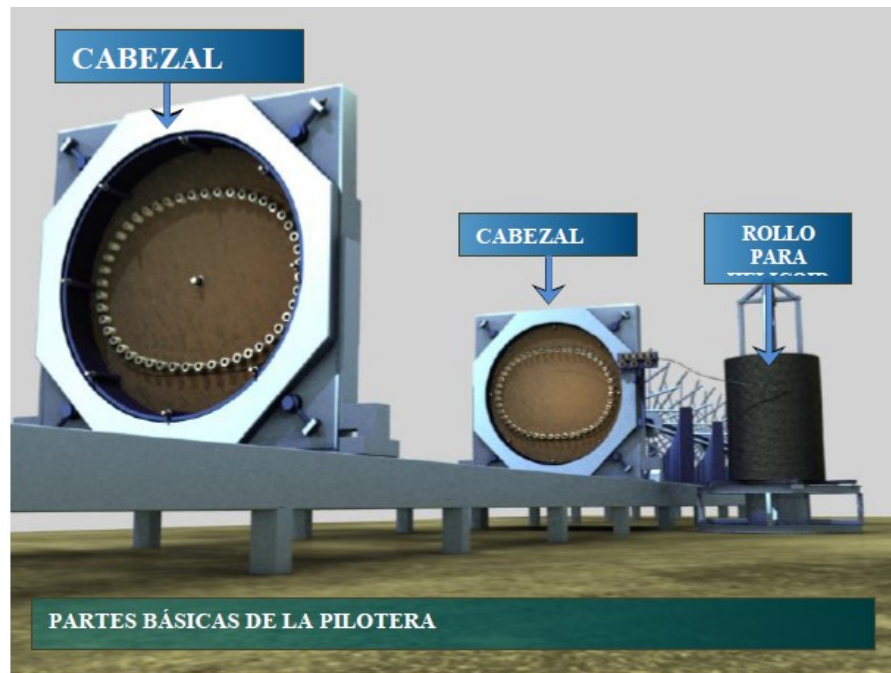
Figura N°3.3: Pilotera, para construcción de armadura del pilote.
