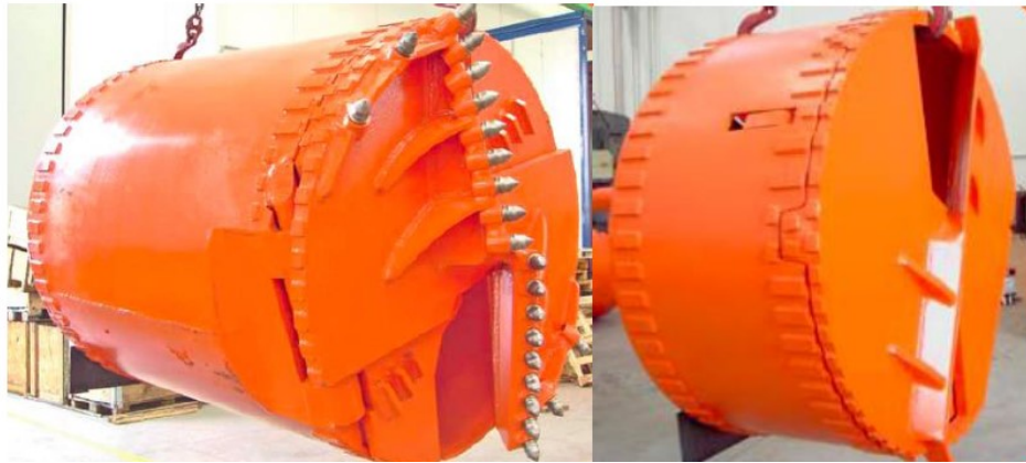
Figura N°3.7: Izquierda: Bucket de doble entrada, derecha: Bucket de limpieza
