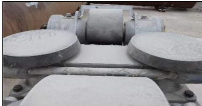
Figura 4.42 Polín de retención de empuje axial con el soporte de polín de rodadura.
