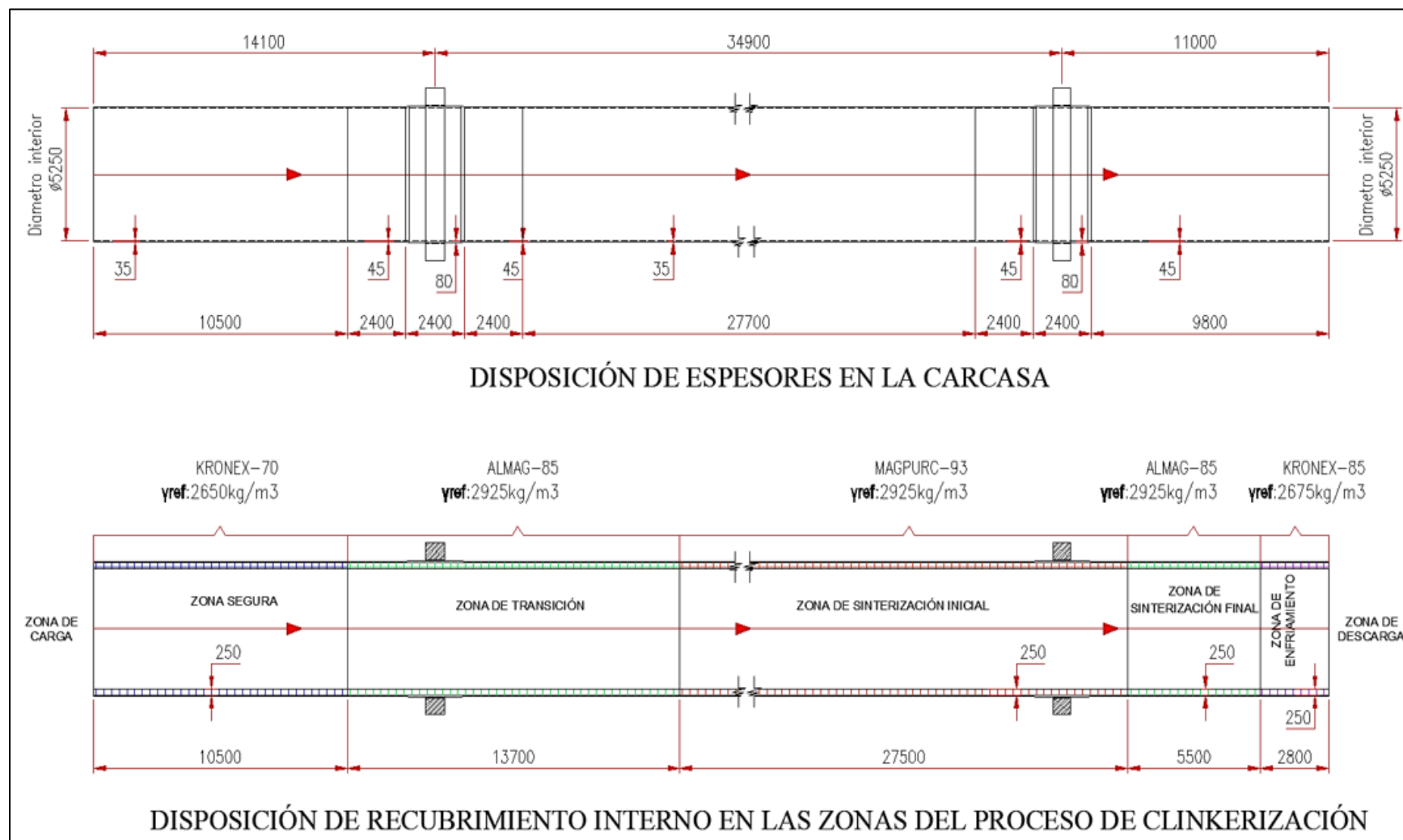
Figura 5.1 Disposiciones de los espesores de carcasa y recubrimiento interno en las zonas del proceso de clinkerización.
