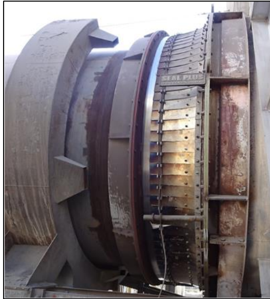
Figura 4.53 Sello de laminillas externas con fuerza de sellado por cuerda con pesos.
