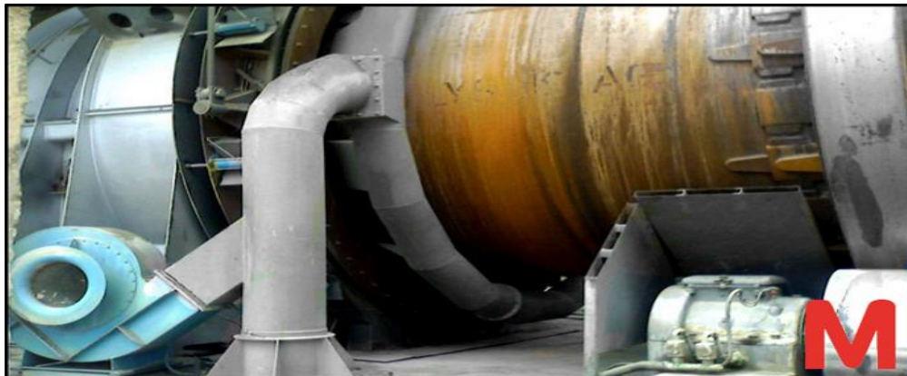
Figura 4.57 Sistema de enfriamiento del extremo de salida del horno.
