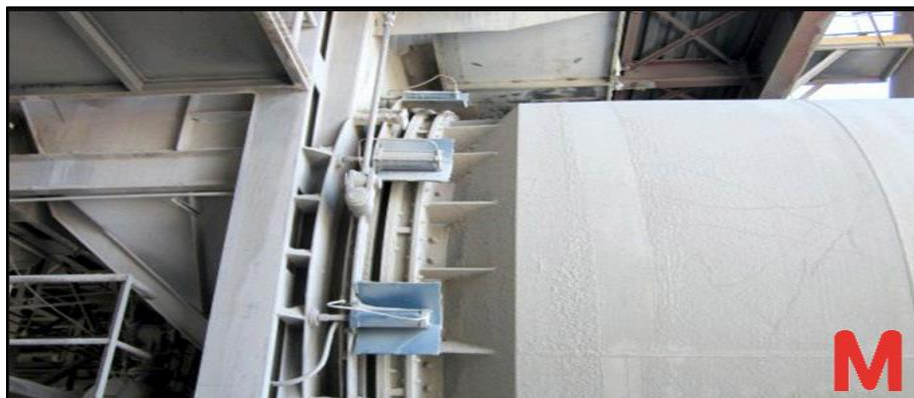
Figura 4.54 Sello por fricción axial con fuerza de sellado por cilindros neumáticos.
