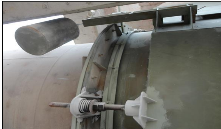
Figura 4.55 Sello por fricción axial con fuerza de sellado por palanca y contrapesos.
