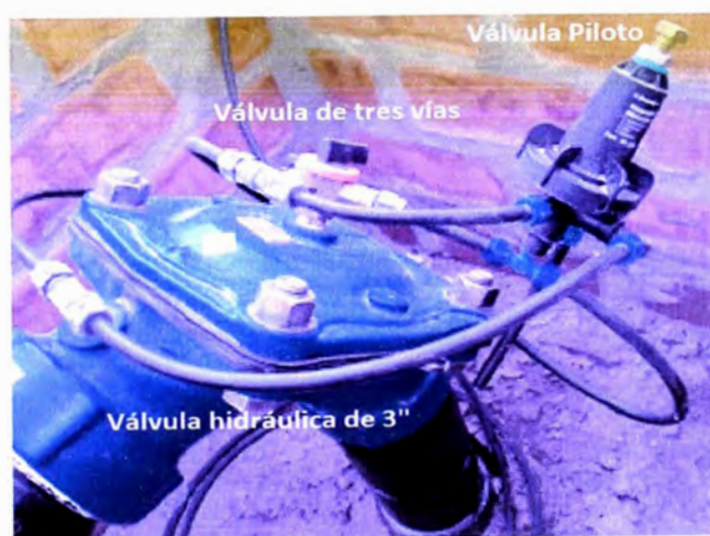
Figura 4.6. Válvula hidráulica de riego con sus componentes.
