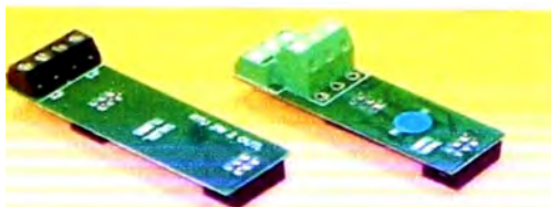
Figura 4.18. Tarjetas de expansión del tablero RF RTU Fuente: NETAFIM
