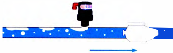
Figura 2.15. Válvula de aire de doble efecto. Fuente: A.R.I.
