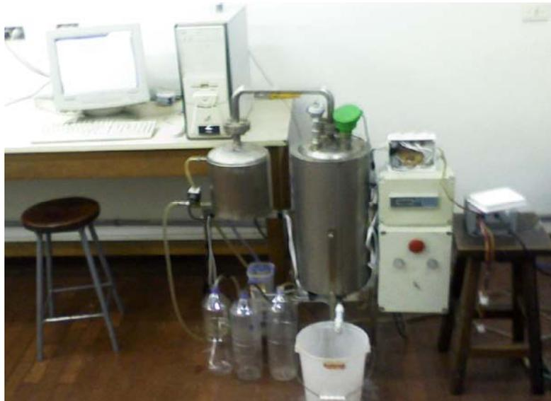
Figura 4.1. Equipo destilador existente en la Universidad Nacional de Ingeniería
