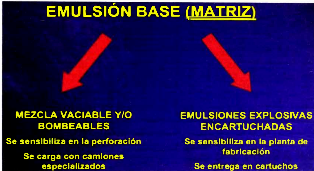
FIG N° 6: Emulsión matriz, bombeable y explosiva.
