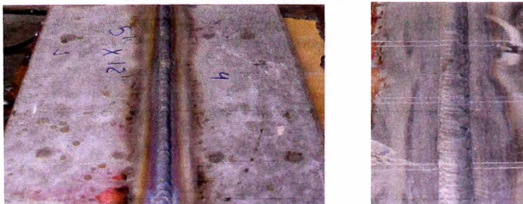
Figura 6.12: Planchas para calificación terminadas
