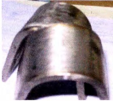
Figura 6.14: Probetas ensayadas a doblé de cara y raíz
