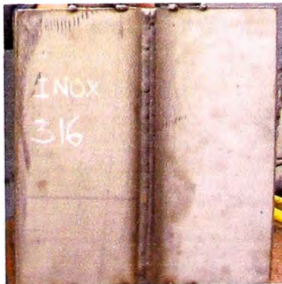
Figura 6.3: Planchas, terminadas para calificación de procedimiento
