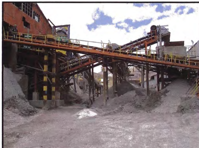
Figura 1.5 – Sección de Chancado de la planta
