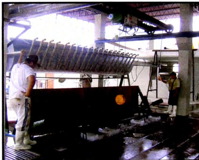
Figura N° 4.15: (Puente de grúa, yugo y poza desmolde)
