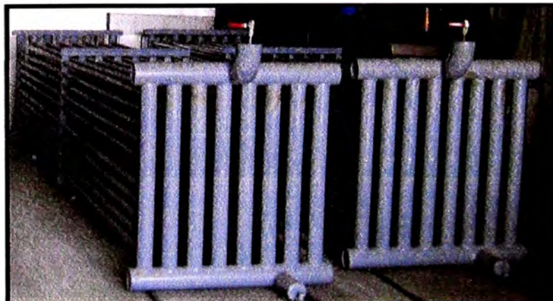
Figura N° 4.6: (Evaporador tipo sumergido, diseño MEBRAFE)
