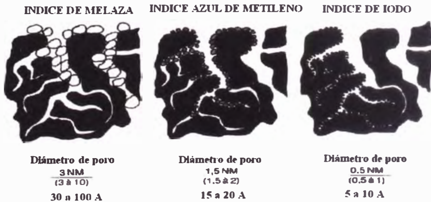
Figura 2.3 Prueba de propiedades absorbentes de carbón (índice)
