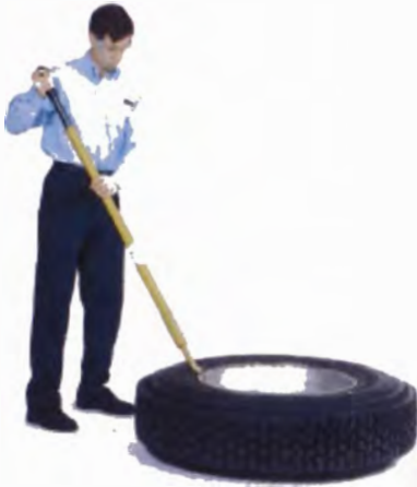
Fig. N° 3.1 Desarmando la Llanta Fig. N° 3.2 Midiendo la Presión de la Llanta
