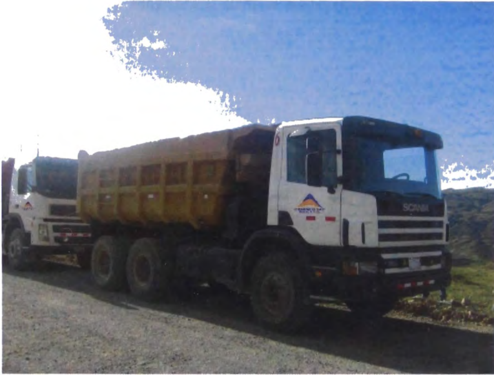
Fig. N° 2.1 Camión SCANIA Modelo P360 (6X4).
