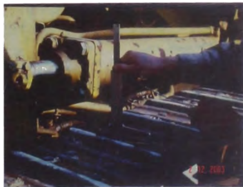
Fig. N° 3.5 Medición de los Segmentos. Fig. N° 3.6 Medición de las Zapatas.
