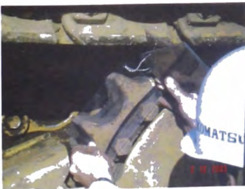
Fig. N° 3.5 Medición de los Segmentos. Fig. N° 3.6 Medición de las Zapatas.
