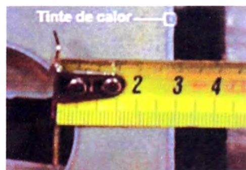
Figura 4.4 Tinte de calor de más de 10 mm
