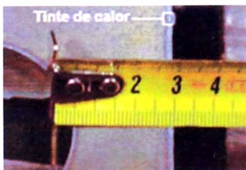
Figura 4.3 Tinte de calor de sólo 2 mm.
