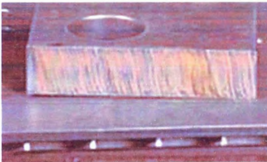
Figura 4.1 Corte de placa de 30 mm (1,18 pulg.) con una antorcha manual de plasma Powermax. El corte por plasma Powermax es bastante uniforme y libre de escoria.
