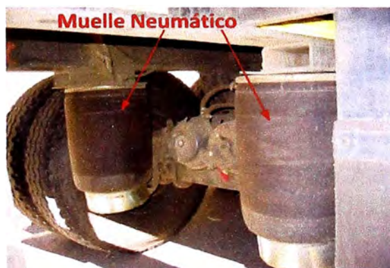
Figura 2.3: Muelle neumático montado en su unidad
