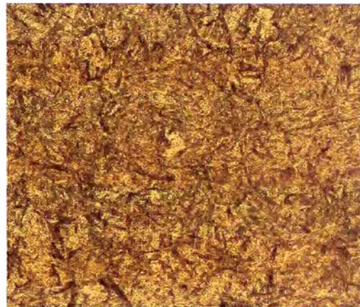
Figura 3.6: Microfotografía de estructura Martensítica a 500x
