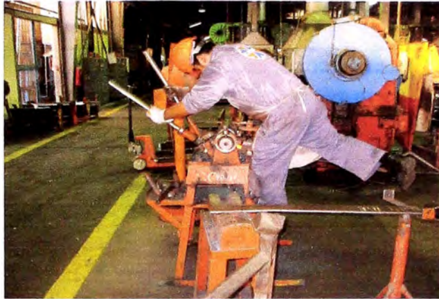
Figura 3.15: Fotografía de la Operación de Formado de Doblez
