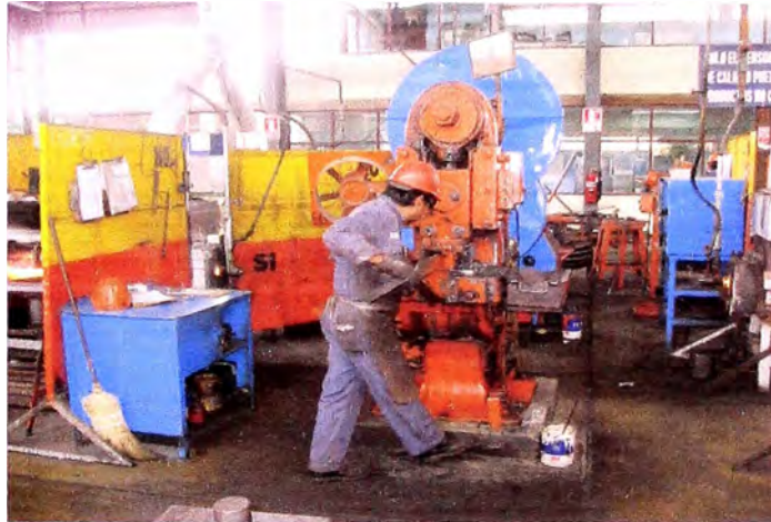
Figura 3.17: Fotografía de la Operación de Corte Lateral
