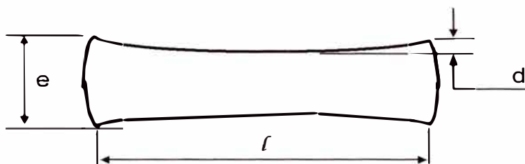
Figura 5.8: Geometría real de la sección plana para las hojas de muelle
