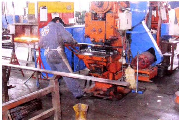
Figura 3.18: Fotografía de Prensa donde se hacen las operaciones de nervadura y oblea
