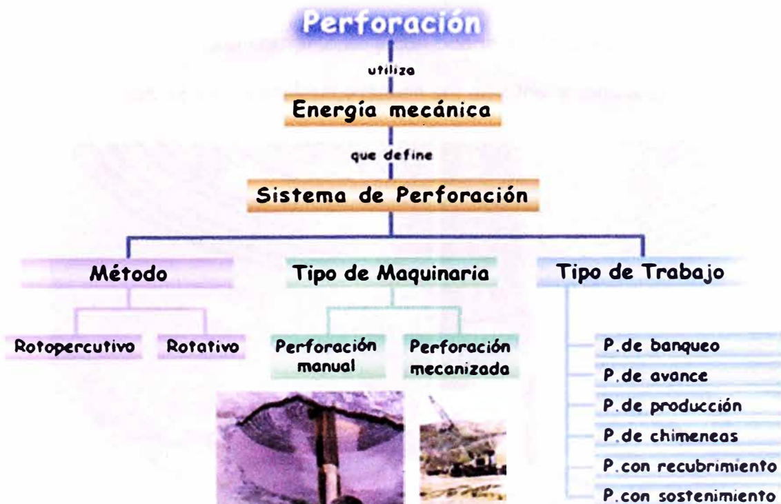
Figura N° 2.2 Métodos de perforación de rocas
