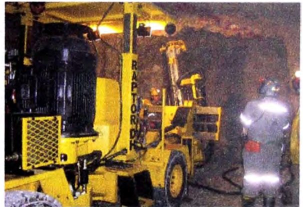
8. Perforacion de explotación o de producción realizado por un Raptor DH de RESEMIN S.A – Empresa Peruana
