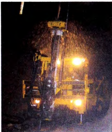
El Raptor DH ingresa cuando se llegó al cuerpo o veta de mineral, siendo este mineral llevado a la planta concentradora
