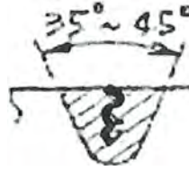
Gráfico 3.2 Angulo de bisel en la reparación de rajaduras
