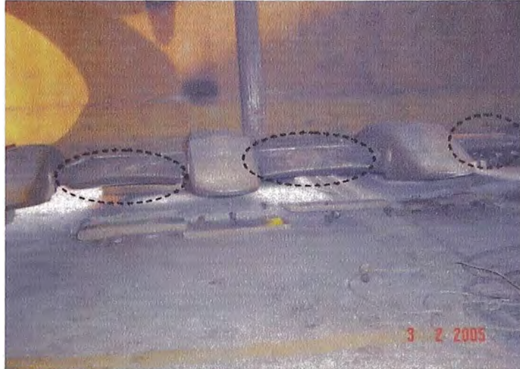
Gráfico 2.17 Desgaste en los entredientes
