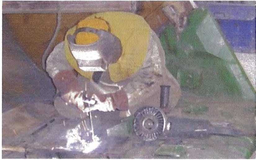
Gráfico 2.24 Soldador suelda con proceso SMAW
