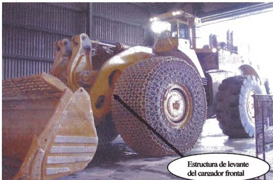
Gráfico 4.1 Ubicación de la estructura de levante en el cargador frontal
