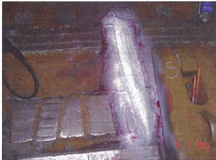
Gráfico 2.26 Ensayo de tintes penetrantes en bisel.
