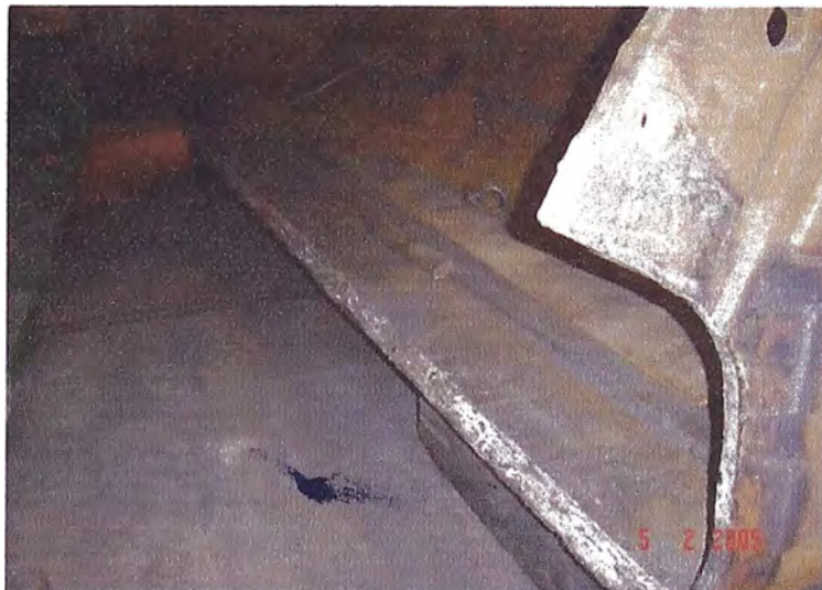
Gráfico 2.23 Corte de bisel terminado con proceso Arc Air
