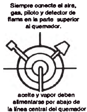
Figura 2.17. Conexiones para un quemador tipo dual.
