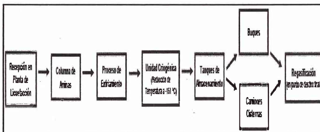
Gráfico 2.4 - Diagrama de Bloques de la Planta de Licuefacción del GN.
