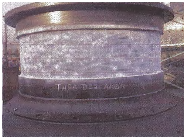
FIG 3.7. PRUEBA DE TINTE PENETRANTES EN PISTA DE RODADURA.
