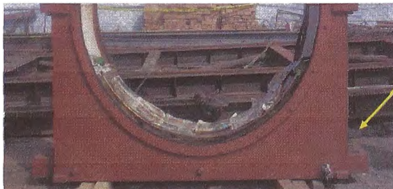
FIG 3.4. VERIFICACION PLANITUD EN BASE INFERIOR.
