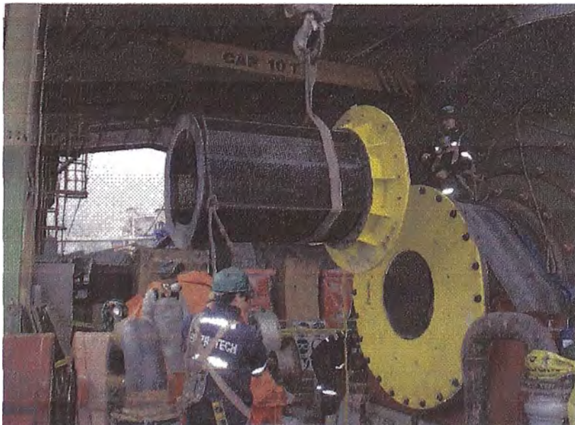
FIG 2.3 TROMMEL DE MOLINO FULLER 13'x17'.
