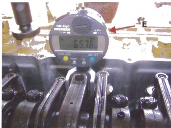
Figura N° 3.15: Ajuste de la sincronización de combustible.
