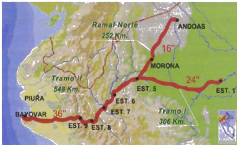
Figura N° 1.1: Ubicación del Oleoducto Nor Peruano y Estaciones de Bombeo.
