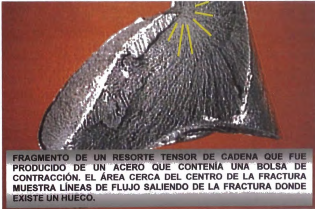
Figura N° 4.7: Problemas de laminado. (Bolsa de Contracción)
