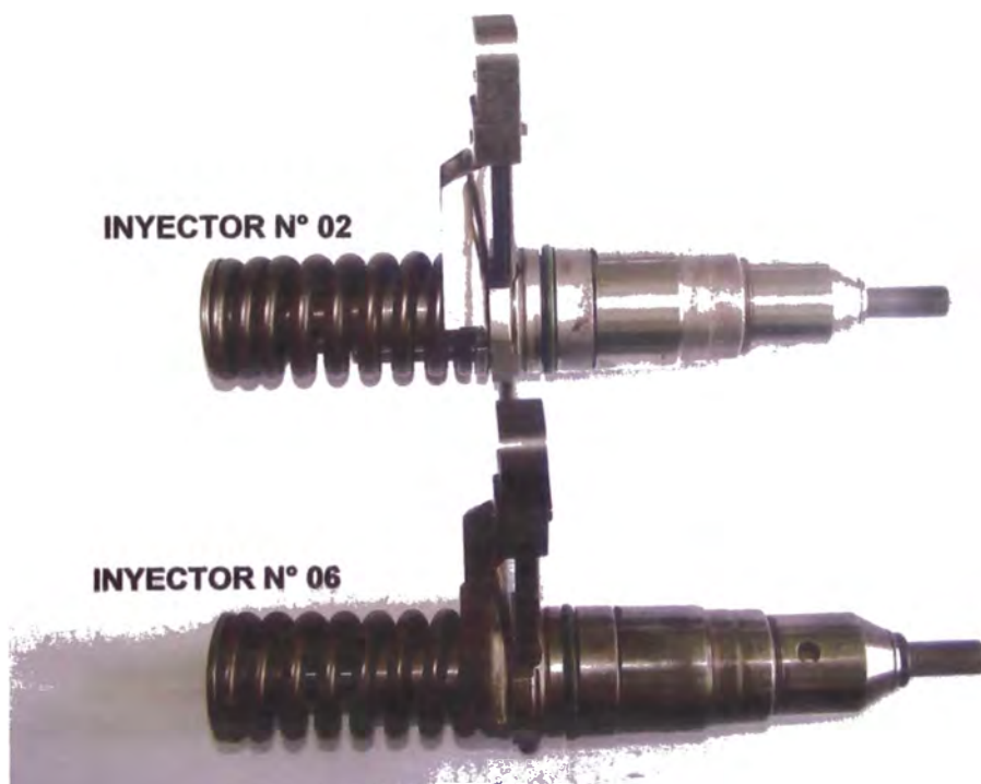
Foto N° 5.18: Inyectores 02 y 06, con ligera des-coloración en las puntas.
