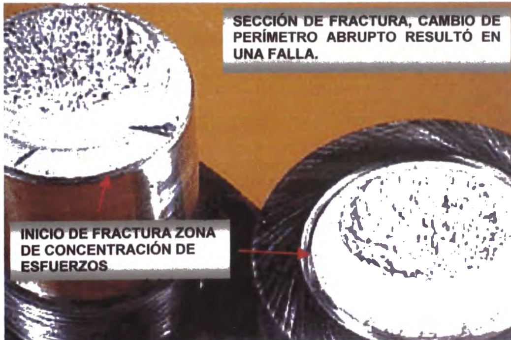
Figura N° 4.11: Problemas de Maquinado. (Concentradores de esfuerzos)
