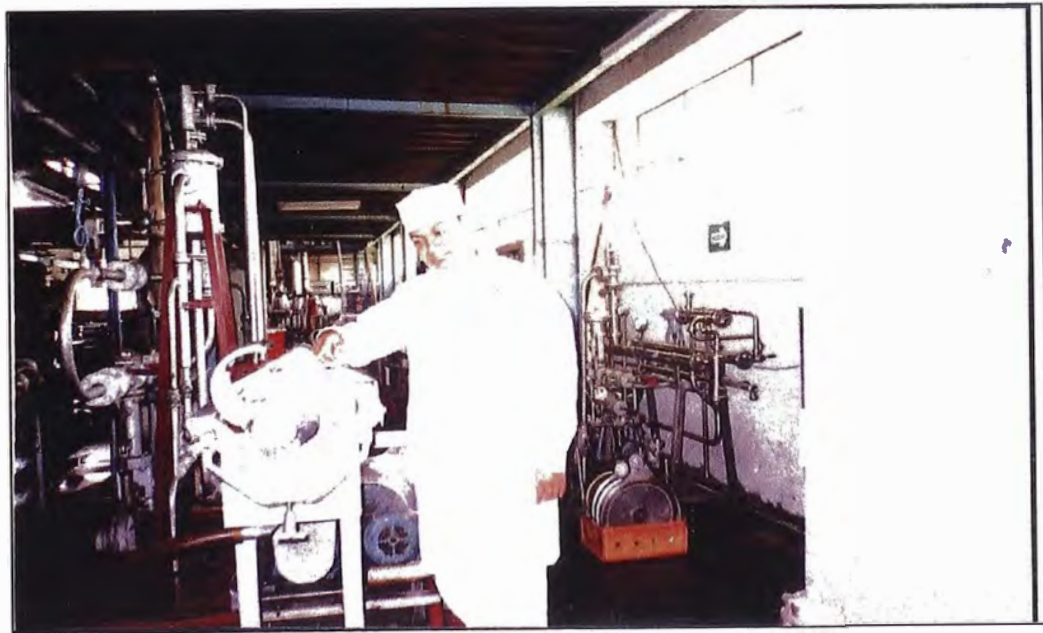
Foto N°2: Equipo piloto – Tornillo sin fin utilizado para obtener el licor del limón
