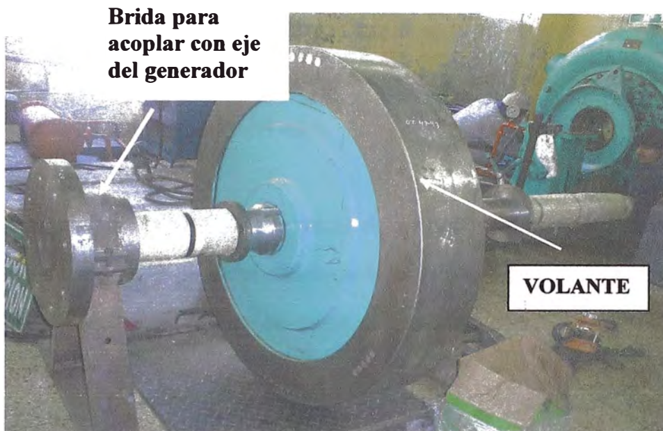
Foto N° 3.3 Muestra al eje con su volante, y en lado izquierdo la brida para acoplamiento con el eje del generador.
