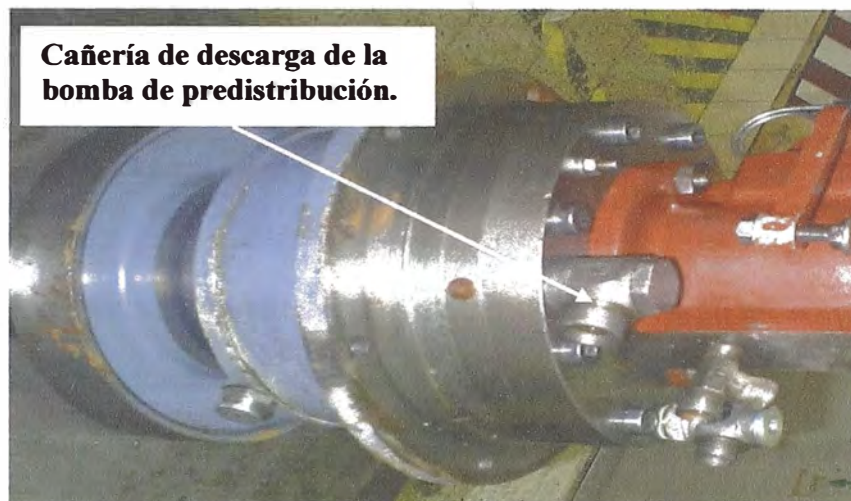
Foto N° 4.6 Vista del cuerpo principal de la predistribución.
