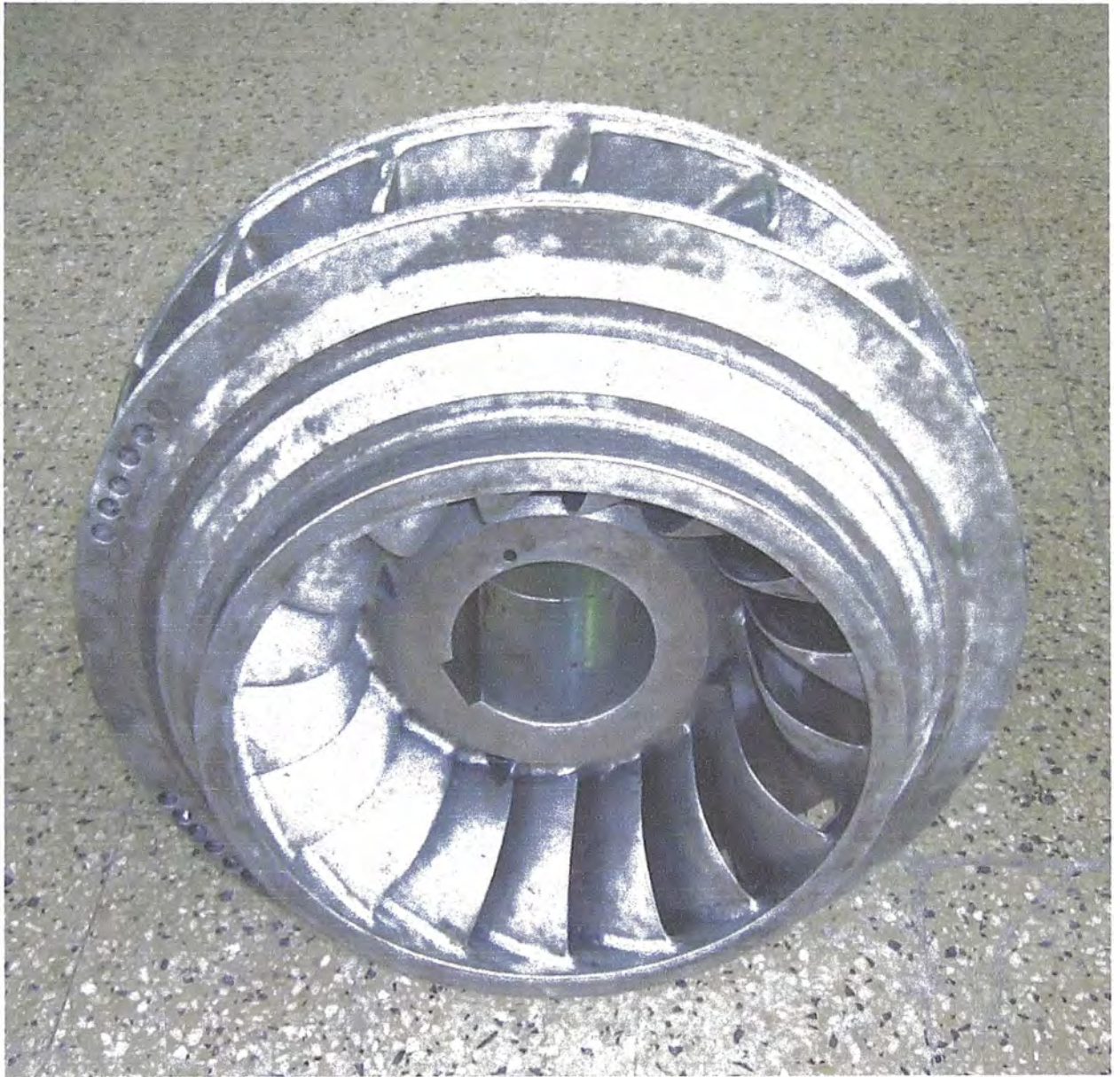
Foto del rodete de la turbina Francis en mención.
