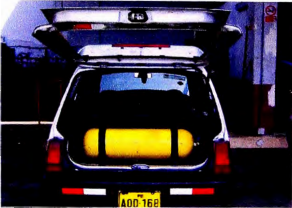
Tanque de 40 Lts. instalado en auto Daewoo Tico
