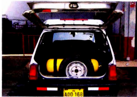
Tanque de 40 Lts. con llanta de repuesto
