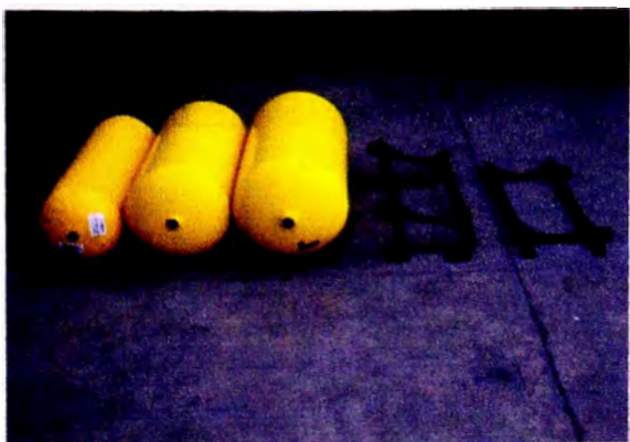
Tanques de 40, 57 y 62 Lts. y soporte de cilindros
