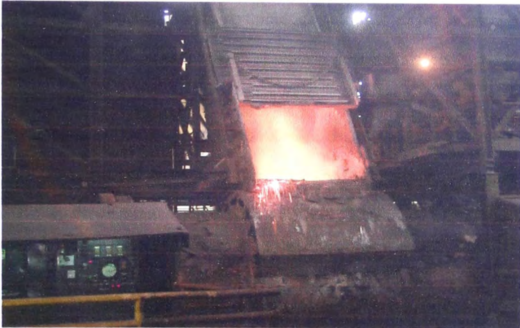
Figura 3.5. Etapa de soplado de gases para el Convertidor Pierce Smith
