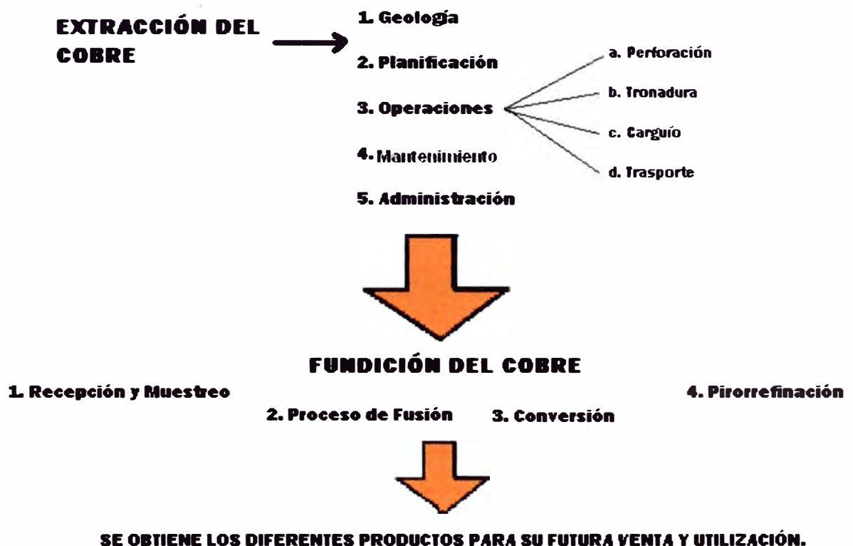
Figura 3.3. Etapas del Proceso Productivo del Cobre
