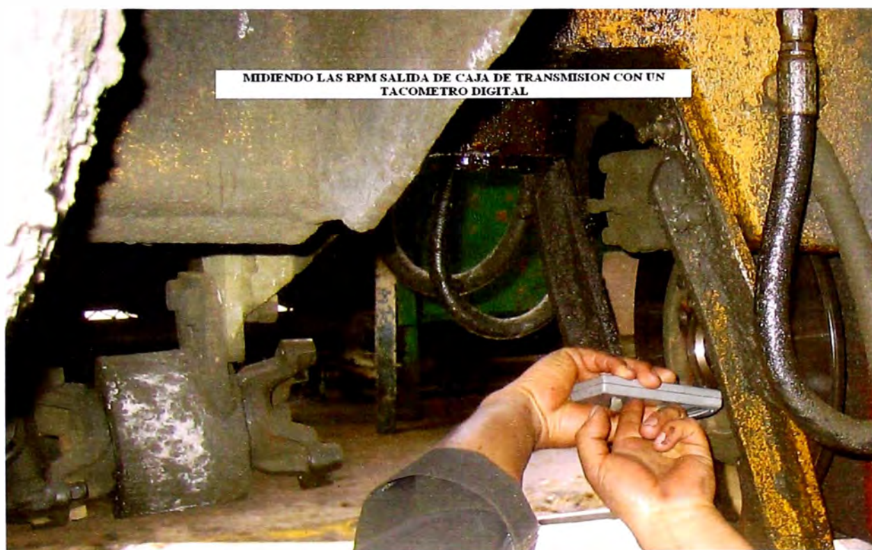
Figura 15 Medición de las RPM
