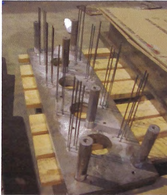
Figura 3.69 Placa porta expulsores, espigas expulsoras y pernos de sujeción
