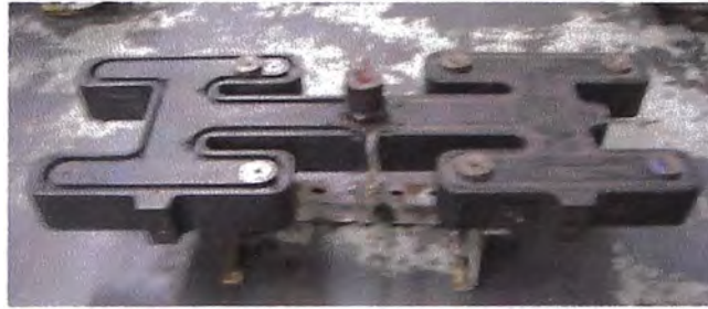
Figura 3.71 Sistema de colada caliente: El manifold (distribuidor de la colada)
