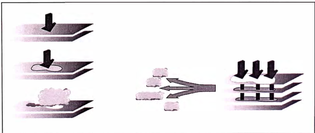
Fig. N°7.3 Perforación del aislante en un condensador
