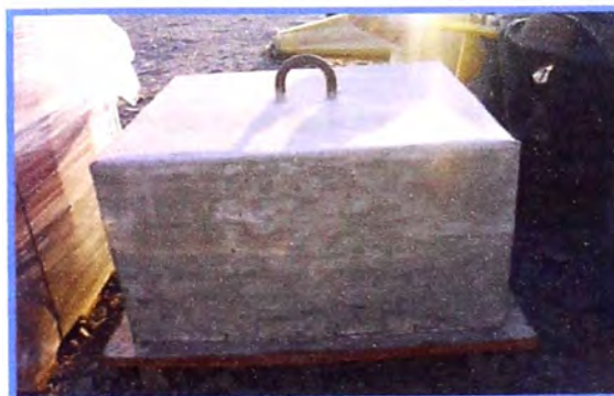
Fig. 2.6: Muerto de anclaje o sinker
