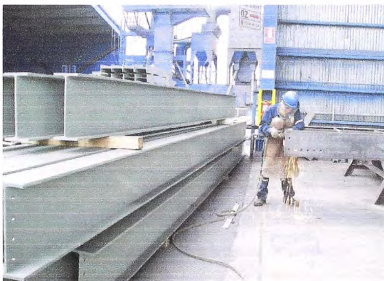
Fig. 3.12 Perfiles Almacenados en lugar inadecuado
