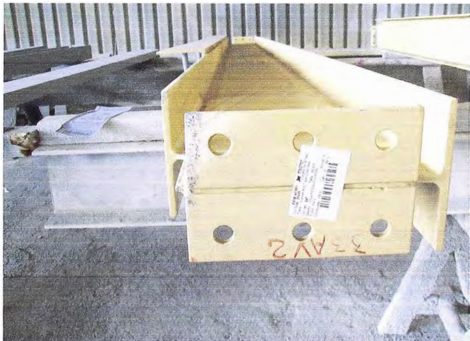
Fig. 3.9 Viga dañada por manipuleo inadecuado
