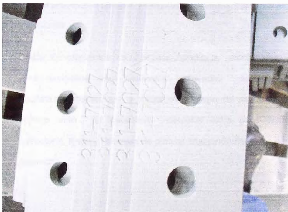
Fig. 3.6 Perfiles angulares contaminados con pintura base.
