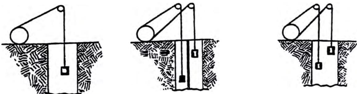
Fig. 2.1 Winches de Tambor de un Skip, Skip - Contrapeso y doble Skip
