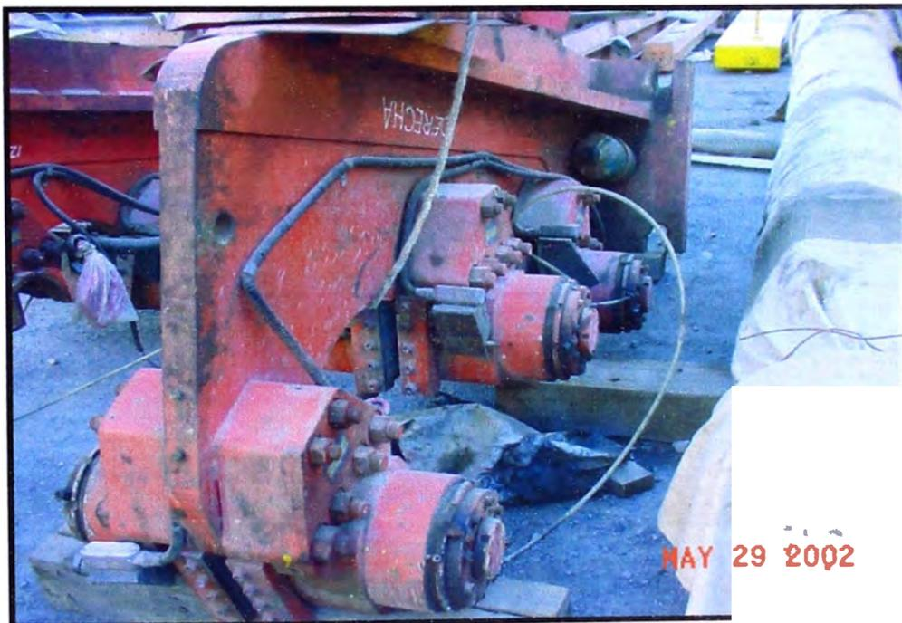
Foto 4.5 Columna de freno del Winche
