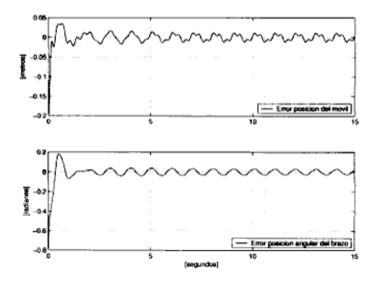
Figura 5.7: Error de posición Móvil-Varilla para el caso de referencia senoidal.
