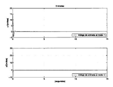
Figura 5.4: Señales de control para el motor 1 y para el motor 2 para el caso de referencia constante.
