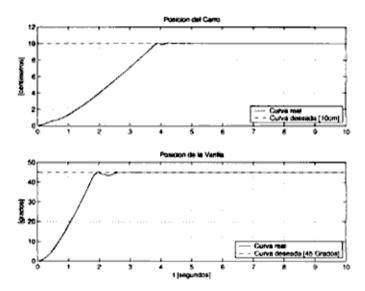
Figura 6.1: Posiciones controladas del carro y el brazo para el caso de referencia constante.
