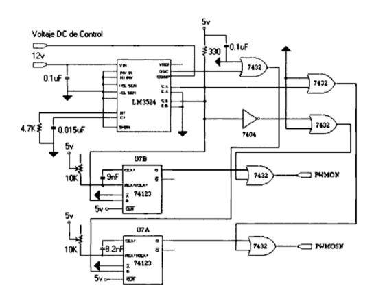
Figura 4.4: Circuito generador de PWM.
