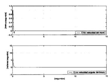
Figura 5.3: Error de velocidad Móvil-Brazo para el caso de referencia constante.
