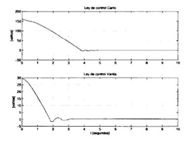
Figura 6.3: Señales de control para el motor 1 y para el motor 2 para el caso de referencia constante.
