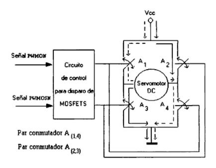
Figura 4.6: Esquema del circuito de disparo y conmutación.
