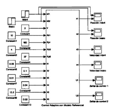
Figura B.1: Bloque principal control adaptivo del MRTM de 2DOF.
