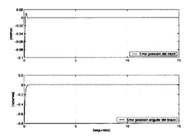
Figura 5.2: Error de posición Móvil-Brazo para el caso de referencia constante.
