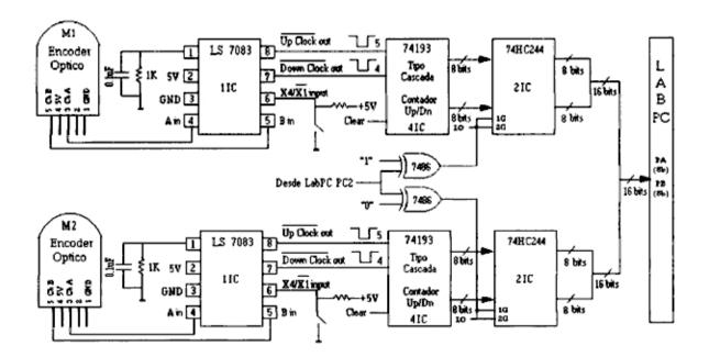
Figura 4.9: Sensado de posición.
