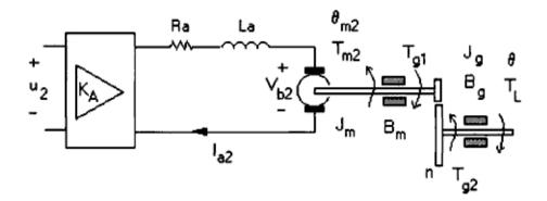
Figura 2.4: Subsistema del torque del brazo.
