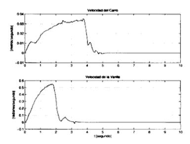
Figura 6.2: Velocidades controladas del carro y el brazo para el caso de referencia constante.
