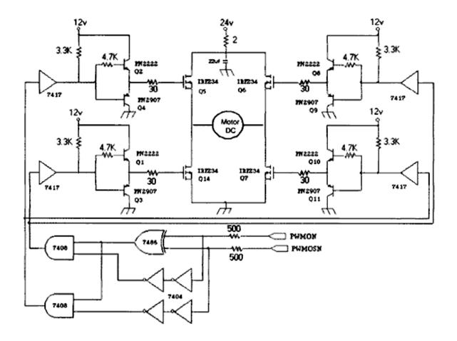
Figura 4.7: Circuito amplificador de potencia de PWM.
