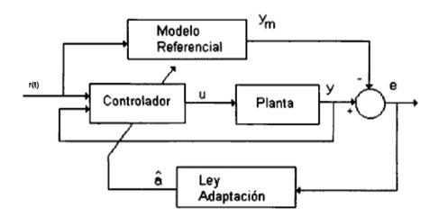
Figura 3.1: Construcción de un MRACS.
