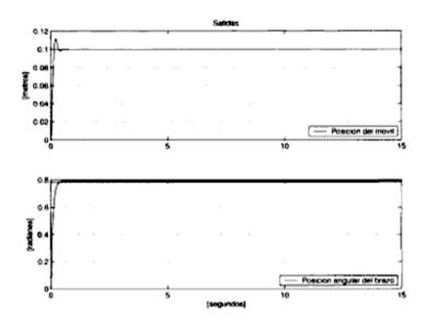
Figura 5.1: Posiciones controladas del carro y del brazo para el caso de referencia constante.
