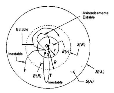
Figura 3.2: Estabilidad en sistemas autónomos.
