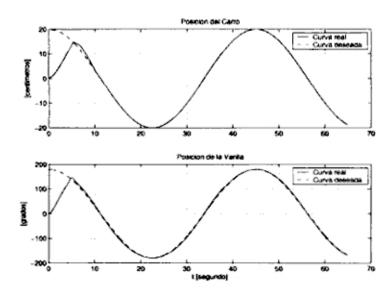
Figura 6.5: Trayectorias controladas del carro y del brazo para el caso de trayectoria senoidal.
