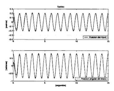
Figura 5.6: Trayectorias controladas del carro y del brazo para el caso de referencia senoidal.
