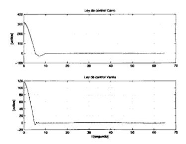
Figura 6.7: Señales de control para el carro y el brazo para el caso de trayectoria senoidal.
