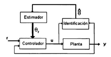
Figura 1.4: Control adaptivo con modelo de Identificación (MIAS).
