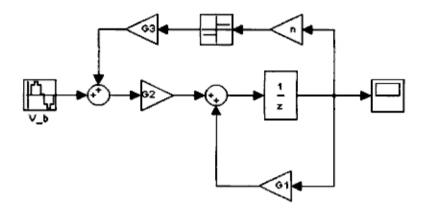
Figura A.3: Modelo discreto del servomotor DC.
