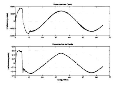
Figura 6.6: Velocidades controladas del carro y del brazo para el caso de trayectoria senoidal.
