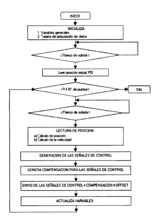
Figura 4.10: Diagrama de flujo del algoritmo de control.
