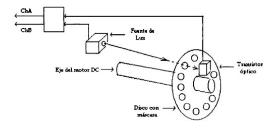
Figura 4.8: Estructura del codificador óptico rotatorio.
