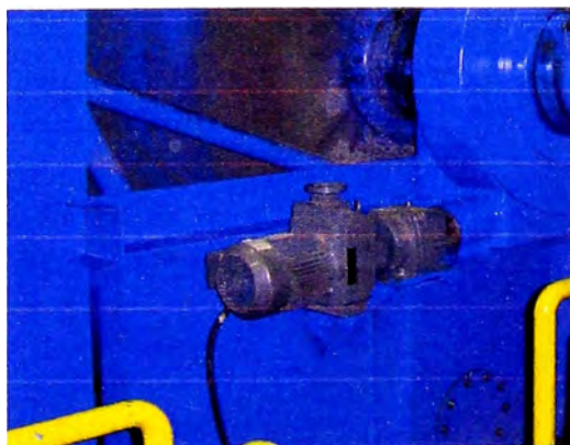
Figura 4.10 Colocación de Motovariador
