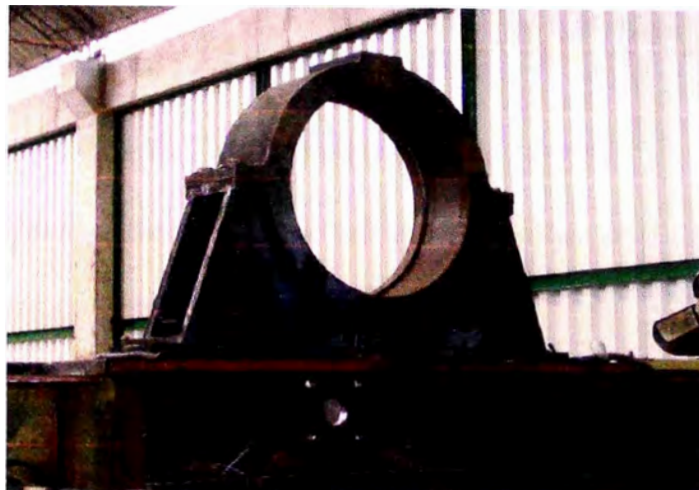
Figura 4.6: Colocación de Chumaceras a la Tina
