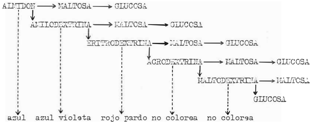
Fig. 3.-MECANISMO DE DESDOBLAMIENTO DEL ALMIDON: REACCION CON IODO
