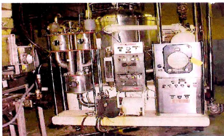
Figura 3.23 Carbonatador para gasificar bebidas en la embotelladora
