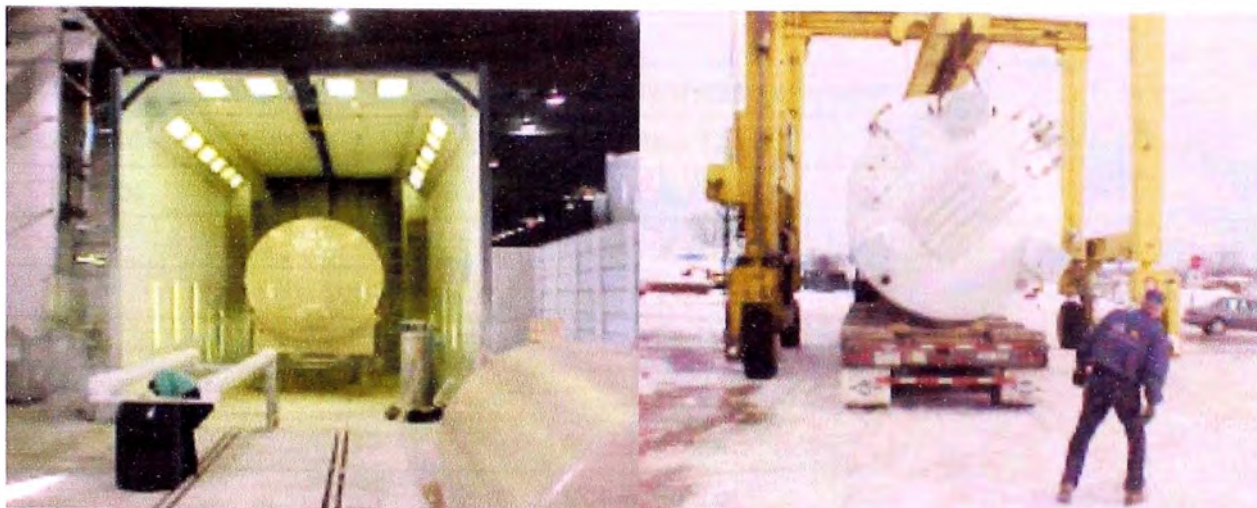
Figuras 5.3 Término de fabricación y traslado al cliente del tanque para CO 2
