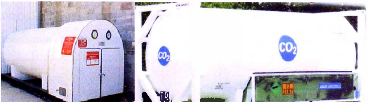
Figuras 2.24 Tanque insulado y aislado al vacío respectivamente.
