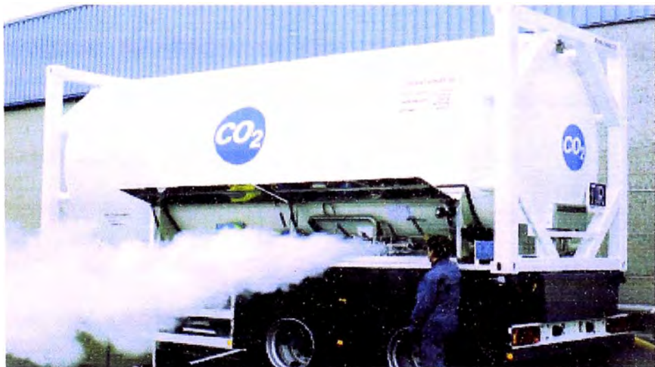
Figura 4.1 Purga de líneas de la cisterna previas a la descarga del CO 2
