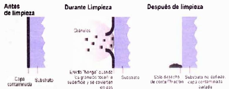
Figuras 3.9 Aplicación en limpieza de superficies con \text{CO}_2
