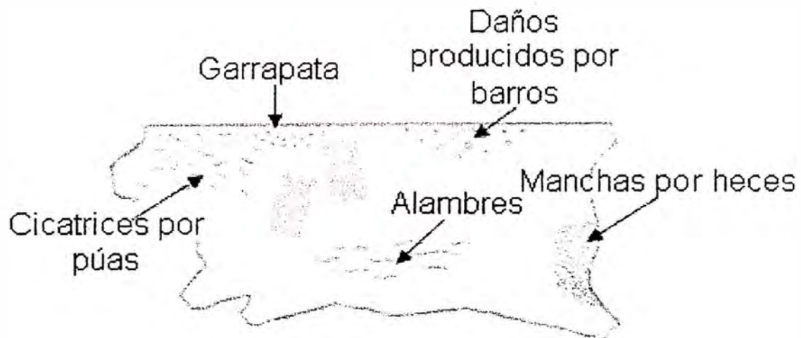
Fig. 2.3 Defectos de la piel en bruto
