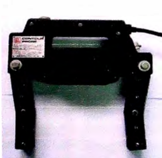
Equipo para partículas magnéticas Yoke, generador de campo magnético
