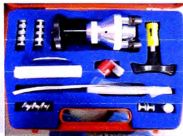
Equipo mecánico para ensayo de Tracción de pintura
