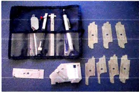
Equipo de Inspección Visual de soldadura
