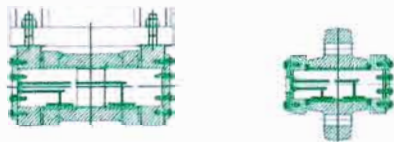
Figura 2.11.- Lubricación de ruedas de balanceo pertenecientes a oruga principal e oruga intermedia CV-019.1 y CV-019.2
