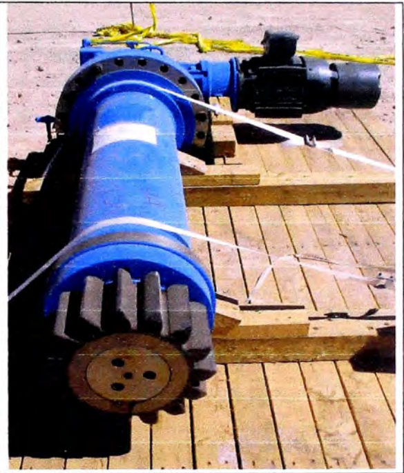
Figura 2.7.-Conjunto Moto reductor y piñón, accionamiento de tornamesa inferior
