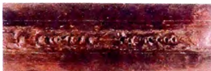
Rajadura longitudinal y porosidad lineal
