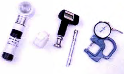
Equipo para medir rugosidad de superficie arenada
