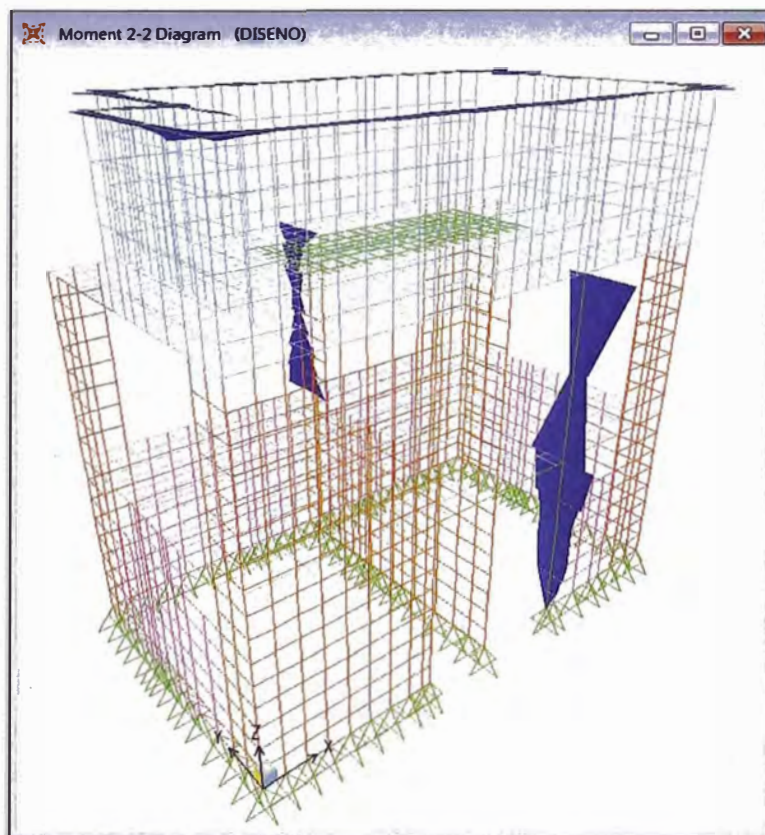
Figura N°2.20.- Diagramas de momentos flectores M2-2 (t-m)
