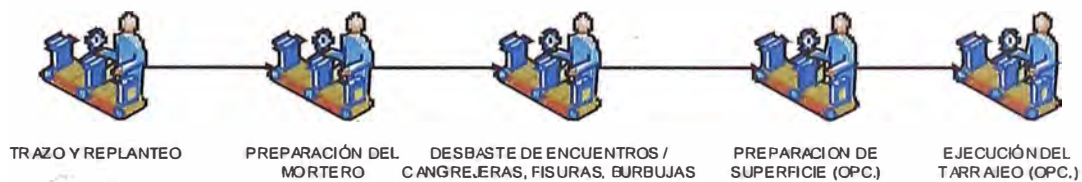
GRÁFICO 2.4. – Diagrama de flujo para solaqueo de elementos verticales de concreto armado
