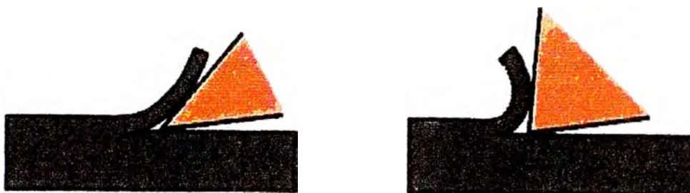
Figura -2- 26 Ángulo de ataque grande = ángulo de filo pequeño. Cuando menor ángulo de ataque tanto mas fuertemente curvada y aplastada resulta la viruta
