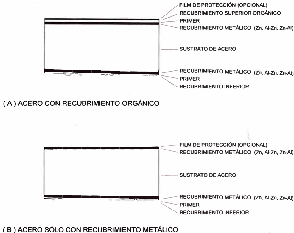
Figura 13. Láminas de acero con sistemas alternativos de protección.
