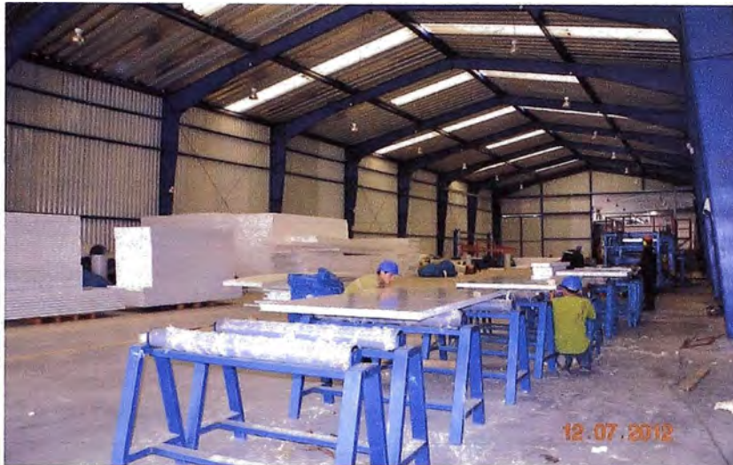
Figura 15. Línea de producción continua de paneles sándwich de EPS.
