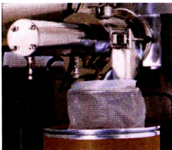
Figura 4.14: Fotografía del sistema de descarga de la granuladora.
