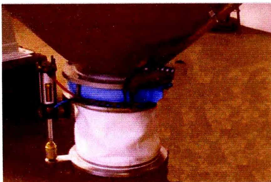
Figura 4.25: Fotografía de la válvula de descarga.
