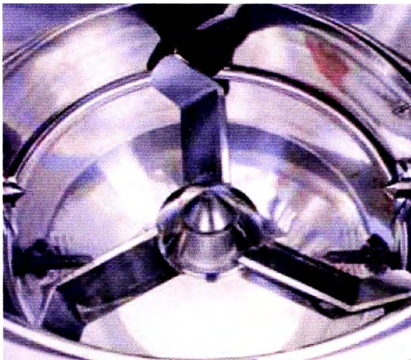
Figura 4.8: Fotografía de las paletas de acero inoxidable.
