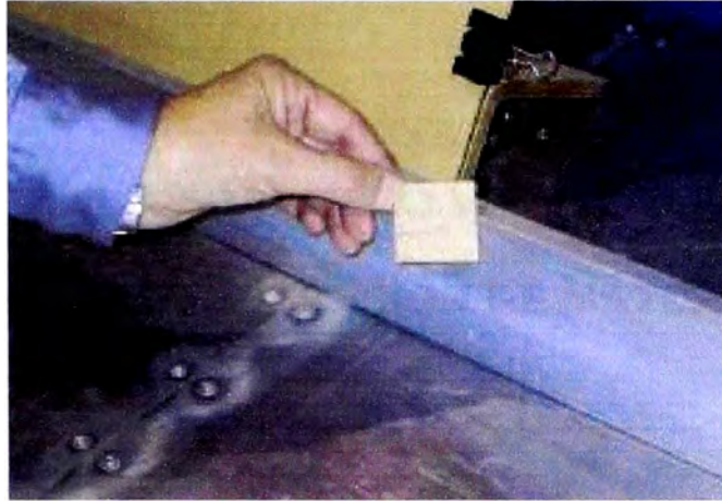
Figura N° 5.41. Pobre practica, una mesa de trabajo echa de aluminio. El oxido de aluminio contamina un espaciador que fue movido a lo largo del borde de la regla de aluminio.
