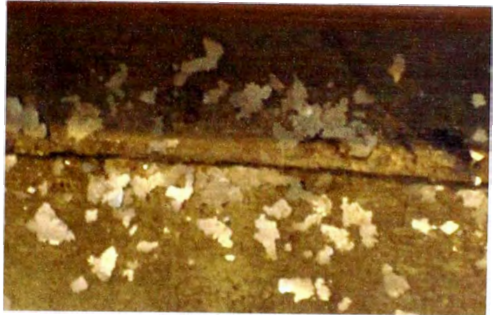
Figura Nº 5.15 (Izquierda). Escamas de hierro generadas por la fricción de las ruedas con los rieles de las gruas, cayendo al piso.
