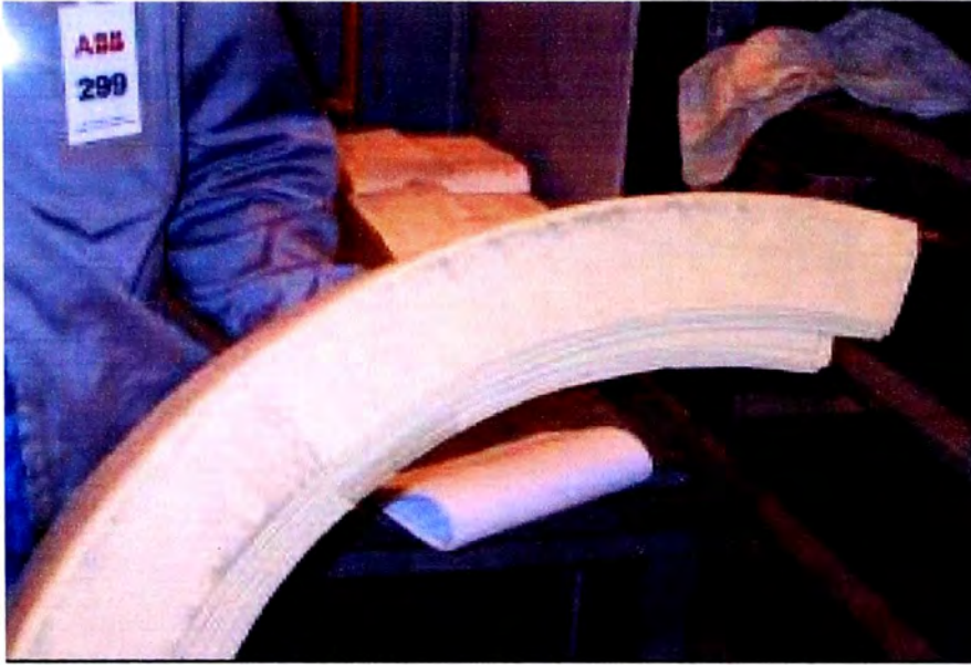
Figura N° 5.10. Este anillo guía debe ser rechazado pues está contaminado. (Los anillos guía van colocados en la parte superior de las bobinas inductoras, sin embargo deben estar limpios.).
