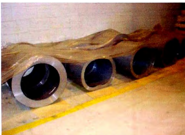
Figuras N° 9.27 y N° 9.28. Pobre practica, Esta no es la forma correcta de almacenar el fierro silicoso, esto puede específicamente incrementar las pérdidas en el fierro. (Si se desea guardar temporalmente el fierro silicoso tal como se muestra debe insertarse un tubo para prevenirse la deformación. La Distorsión del núcleo de acero incrementa las pérdidas en el fierro)
