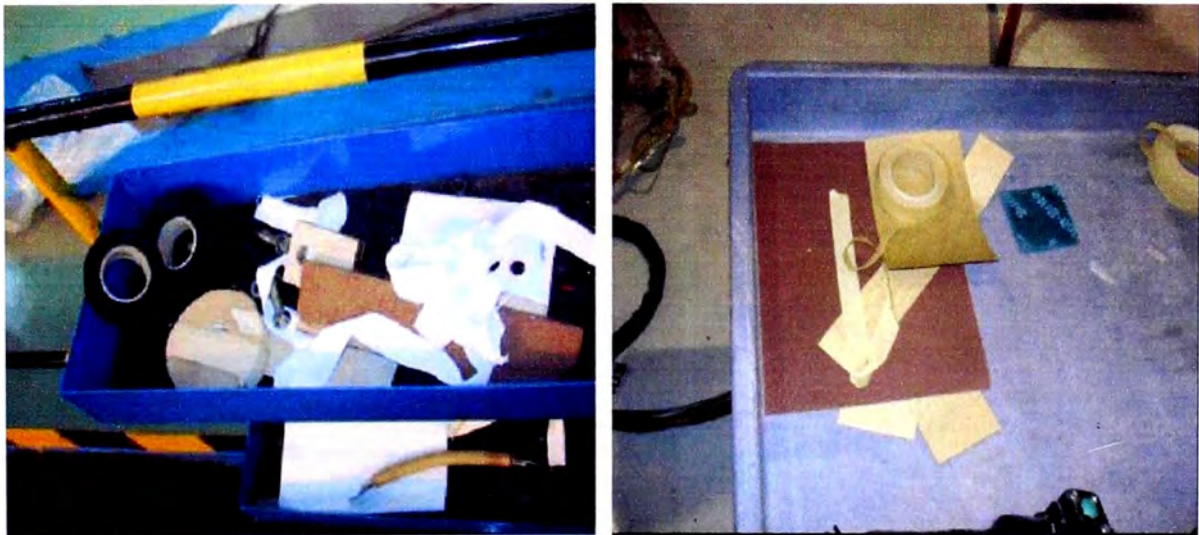
Figura Nº 5.26 (Izquierda). Pobre practica – Material aislante limpio mezclado con cinta carbonizada.
