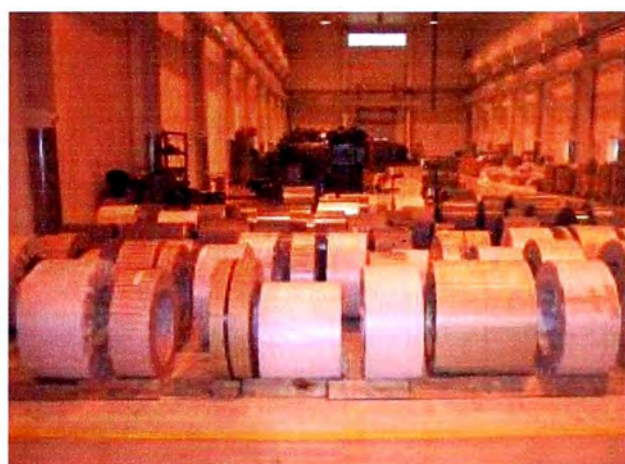
Figuras N° 9.27 y N° 9.28. Pobre practica, Esta no es la forma correcta de almacenar el fierro silicoso, esto puede específicamente incrementar las pérdidas en el fierro. (Si se desea guardar temporalmente el fierro silicoso tal como se muestra debe insertarse un tubo para prevenirse la deformación. La Distorsión del núcleo de acero incrementa las pérdidas en el fierro)
