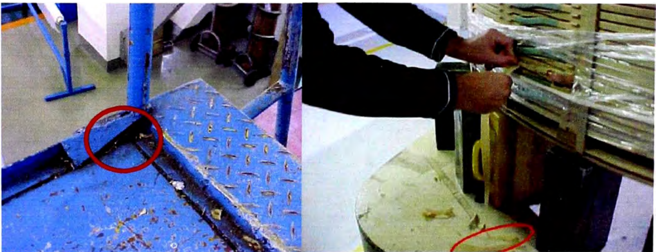
Figura Nº 5.21 (Izquierda). Pobre practica, plataforma de ensamble no esta limpia. Deberia estar limpia, especialmente de particulas de metal
