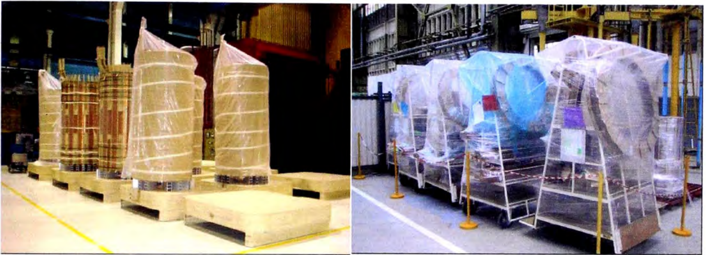
Figura Nº 5.19 (Izquierda). Bobinas cubiertas con plástico – incluso la parte superior ( Las bobinas que se observan sin cubierta acaban de salir del horno.).
