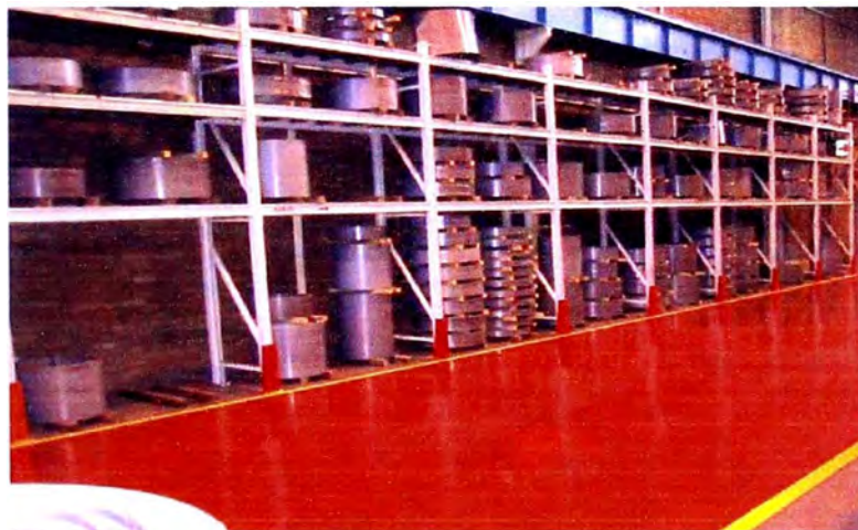
Figura Nº 5.2. Las instalaciones bien iluminadas, el piso sin daños, zonas de transporte claramente marcadas, y los estantes bien organizados y limpios.
