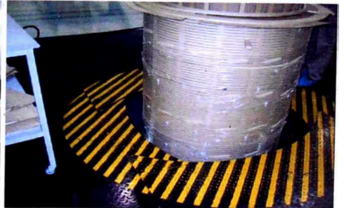
Figura Nº 1.17 (Izquierda). Molde de bobinado cubierto con plastico, incluso cuando se esta bobinando, para prevenir la contaminación
