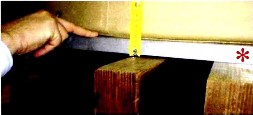
Figura N° 4.2. Este es un bobinado que no esta bajo presión aun, se ha puesto una barra de acero recta (marcado con un asterisco rojo *) a lo largo de los tres bloques y se midió 5 mm de diferencia en la altura de bobinas.
