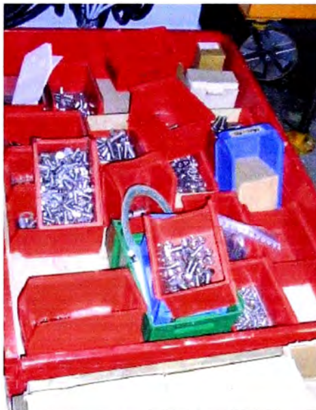
Figura N° 9.30 Pobre practica – Una empaquetadura almacenada entre cajas de pernos que pueden contaminarla o causarles daños de modo tal que después se origina una fuga de aceite. Las empaquetaduras deben ser guardadas con los cuerpos planos y limpios.
