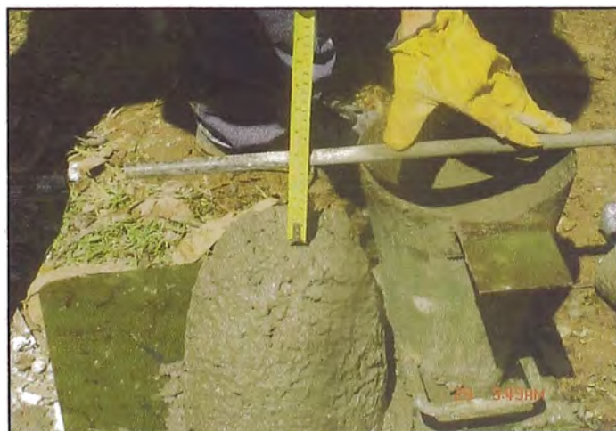
Foto N°5.3: Prueba de Slump para concreto fresco
