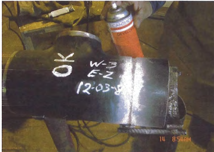
Foto N°5.1: Prueba de tintes penetrantes en Probeta de tubería de acero
