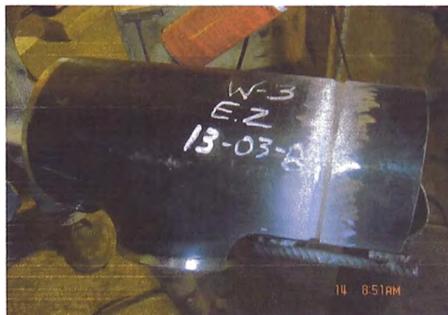
Foto N°4.4: Probeta de tubería de Ø6" para ensayo
