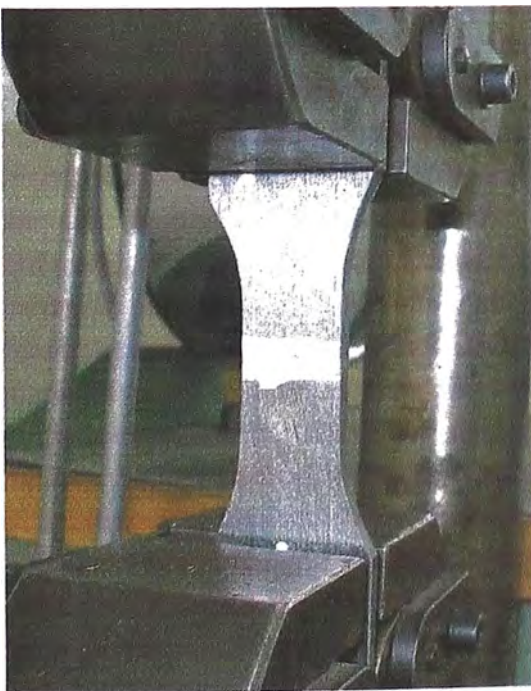
Figuras N°1 y 2: Muestra las probetas montadas en la máquina de tracción.
