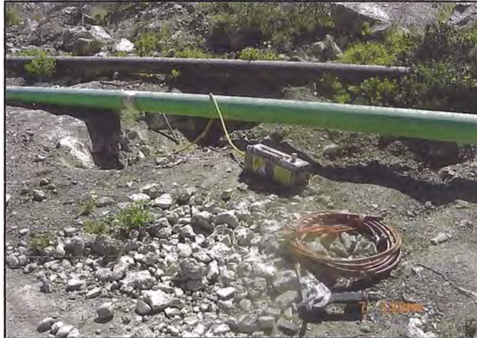
Foto N°5.2: Equipo de Gammagrafia para inspección de soldadura
