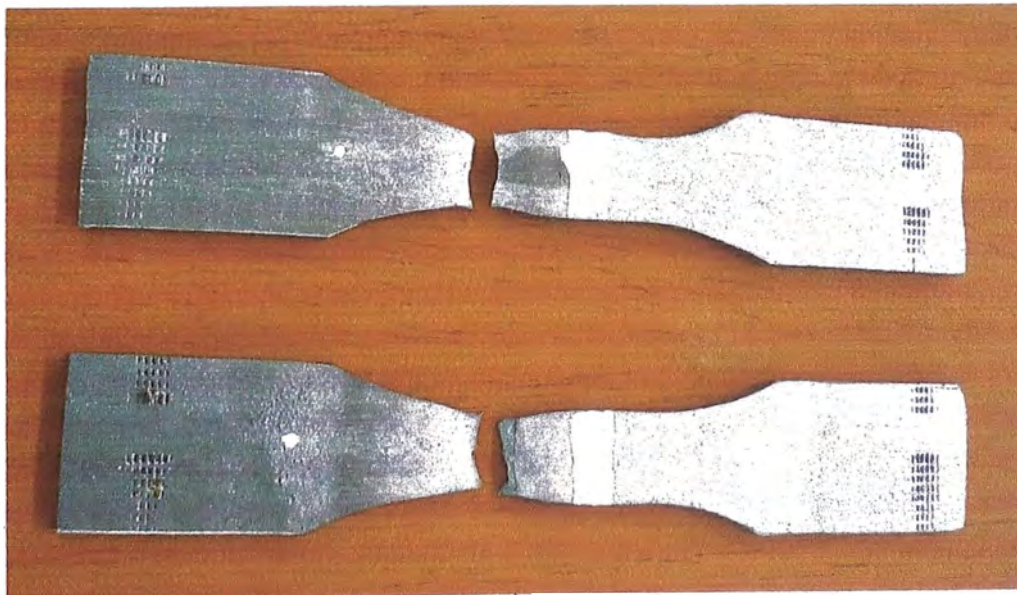
Figura N°3: Muestra las probetas después del ensayo de tracción
